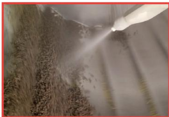
Iniezione delle polveri sul pellet con l'utilizzo di uno spruzzatore TRIBOELETTRICO in un tamburo rotante
